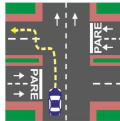
Conversão à esquerda de uma via de mão única para outra com quatro faixas (duas em cada sentido)
